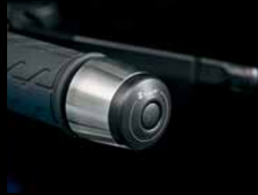
Uravnoveženje krmila 990D0-04K18-000 Iz nerjavečega jekla s plastičnim koncem, srebrne barve s črnim kontrastom in logotipom Suzuki.
