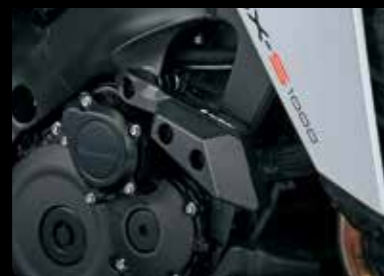
Drsnik za okvir 99114-48K00-000 Pomaga pri zmanjšanju poškodb, izdelan iz aluminija in POM (poliacetala).
