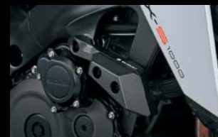
Zaštita motora Smanjuje oštećenje, izrađen od aluminija i ertacetala.
