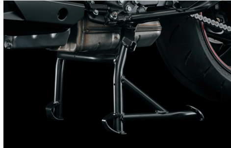
Hlavní středový stojan 42100-48830-000 Uvede motocykl do bezpečné a stabilní polohy pro údržbu a parkování.
