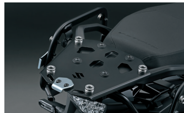
Tûradoboztartó konzol 93800-25850-000 A tûradoboztartó konzol kizárólag az alumínium tûradoboz (93100-25840-000 / 93100-25860-000) felszereléséhez készült. Kérjük, ne használja más célra.
