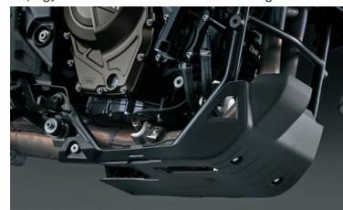
Alsó burkolat 94400-25830-000 További lehetőség a motor védelmére. Bukócsőhöz való csővel (41100-25810-000) együtt használható.
