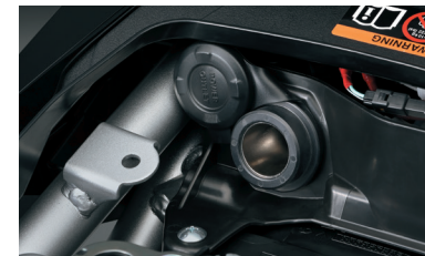
Egyenáramú csatlakozóaljzat 38800-31810-000 Lehetővé teszi, hogy az ügyfelek elektromos eszközöket használjanak. Az ülés alá kell felszerelni.
