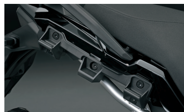
Oldalsó tûradobozhoz való felső tartó 47500-25810-000 A műanyag oldalsó tûradobozkészlet (95400-25810-000) felszereléséhez szükséges. Oldalsó tûradobozhoz való alsó tartóval (93700-25880-000) együtt használható.
