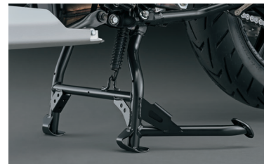
Középgállvány 42100-25820-000 Megbízható és stabil állóhelyzetben tartja a motorkerékpárt a karbantartási tevékenységek idejére.
