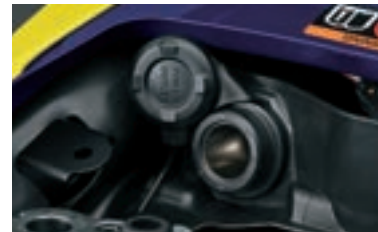
Egyenáramú csatlakozóaljzat 38800-31810-000 Elektromos eszközök használatára biztosít lehetőséget. Az ülés alá szereléshez.
