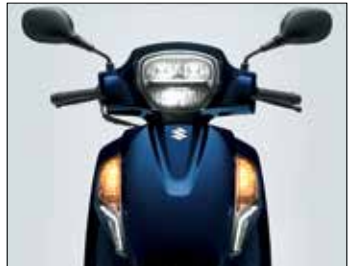
LED-es fényszóró és LED-es helyzetjelző lámpák
