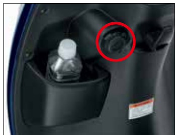
Elülső belső rekesz USB-csatlakozóval
