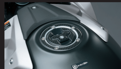
Kryt veka palivovej nádrže 99185-00A00-CRB Slúži na ochranu veka palivovej nádrže pred škrabancami. Dizajn s karbónovým vzorom. Nie je možné kombinovať s prstencovým úchytom pre tankvak (č. dielu 44200-25810-000).
