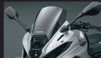
Turistický veterný štít (tónovaný) 94600-25840-000 Tónovaný štít dodáva motocyklu štýlový vzhľad. V porovnaní so štandardným štítom je zvýšený približne o 27 mm.
