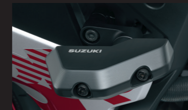
Padací rám 41900-25850-000 Padacie rámy sú cez motocykel na oboch stranách prepojené spojovacou tyčou, čím sa zvyšuje odolnosť konštrukcie. Slúžia na zníženie poškodenia motora a rámu v prípade pádu. S logom SUZUKI. Sada pre pravú a ľavú stranu.
